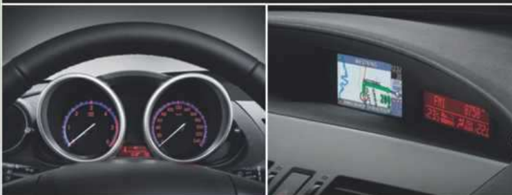
Tradičné ukazovatele sú vsadené v športových tubusoch, medzi nimi je počítadlo kilometrov a ukazovateľ stavu paliva. Údaje palubného počítača a ďalšie informácie sa zobrazujú na stredových displejoch, ktoré sú pomerne malé a ďaleko umiestnené
